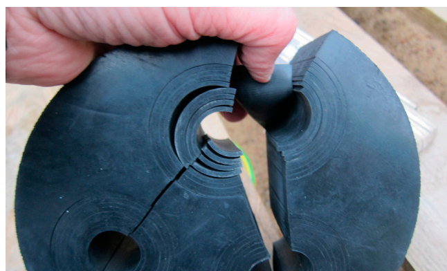
Mittels Segmentringtechnik wird der WE 160-SG 3/22-58 vor Ort auf den Leitungsdurchmesser angepasst.
