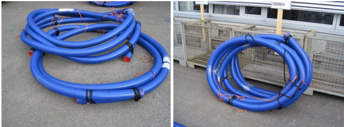
Abbildung 3: Falsch: Wickeldurchmesser zu groß, Gurte lose
