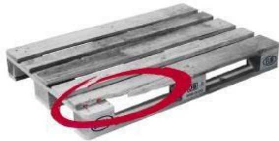
Abbildung 12: Palette – abgesplitterte Bretter
