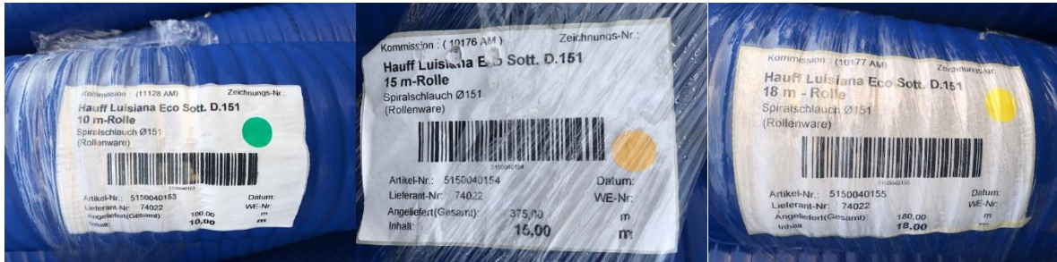
Abbildung 9: Beispiele farbige Kennzeichnung Schlauchrollen
